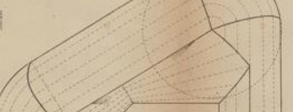
Fig. 6. Kegelwalme in der Draufsicht, wenn die Pfeile auf der geraden Oberfläche angesetzt sind.
