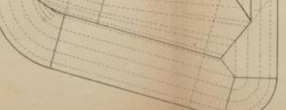
Fig. 5. Kegelwalme in der Draufsicht, wenn die Pfeile auf der geraden Oberfläche angesetzt sind.
