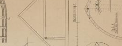
Fig. 10. Kegelwalme in der Draufsicht, wenn die Pfeile auf der geraden Oberfläche angesetzt sind.
