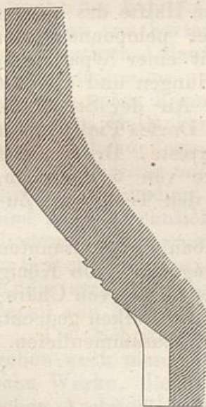
Profil des Säulenkapitäles von der Halle des Philippus zu Delos.
