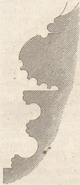
Profil der Säulenbasis des Tempels der Athene Polias zu Priene.
