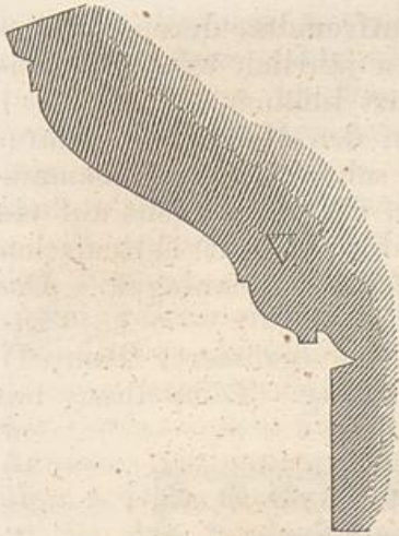
Profil eines Kranzgesimses von Akrae.
