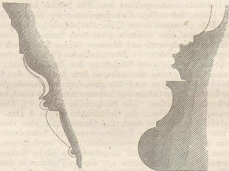
Erechtheion. Profil der Krönungsgesimse der Anten. Säulenbasis des östlichen Prostyls.
