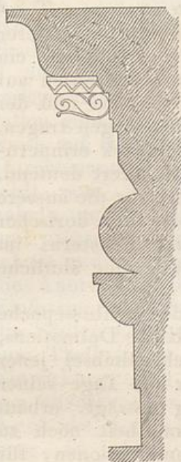
Gebälkprofil im Pallaste des Diocletian zu Spalatro.
