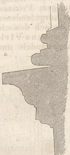
Vestatempel zu Tivoli. Profil der Säulenbasis und der Be- krönung des Unterbaues.
