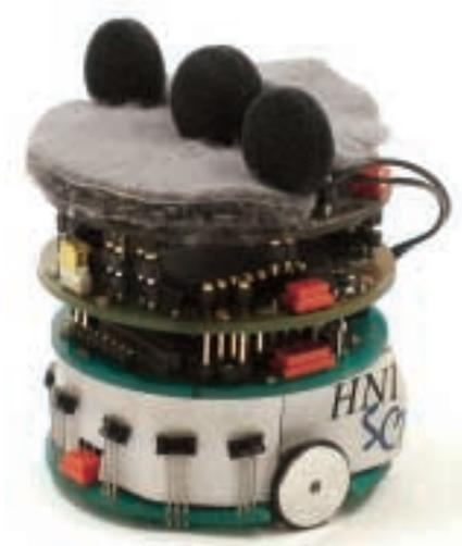
Der Miniroboter Khepera mit einem Ultraschallmodul
