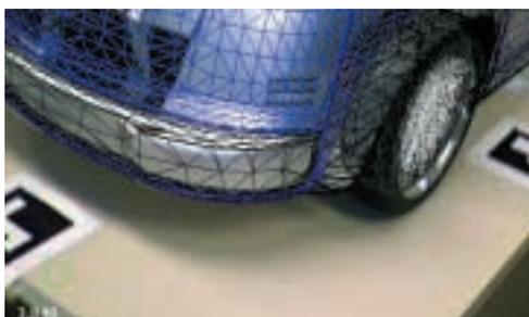
Überlagerung von 3D-CAD-Daten auf eine reale Struktur bei einem VW-Fahrzeugmodell
