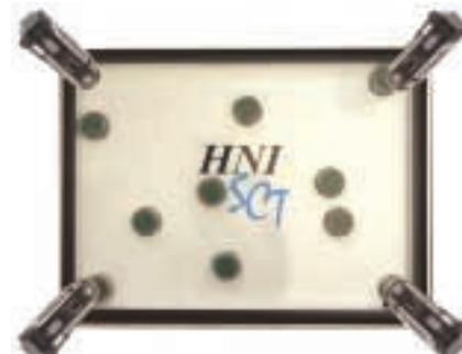
Telewerkbank aus Sicht der fünften Kamera über der Arbeitsfläche. Vier Kameras sind in den Ecken zur Beobachtung spezieller Situationen angeordnet.
