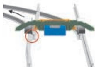
Abzweigen: Das linke Rad läuft mit dem Spurkranz an der abzweigenden Schiene entlang
