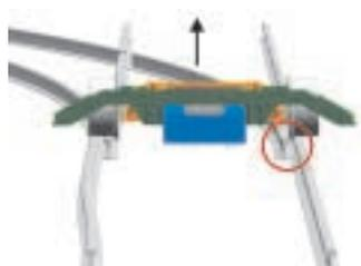
Geradeausfahrt: Das rechte Rad läuft mit dem Spurkranz an der geraden Schiene entlang
