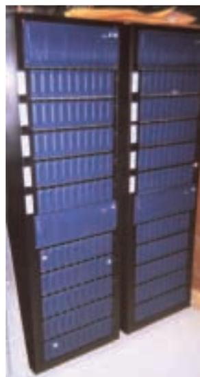
SGI(TM) TP9400 Festplattensystem mit 1 Terabyte Speicherkapazität basierend auf RAID-Technologie
