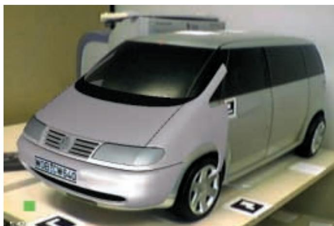
Darstellung unterschiedlicher virtueller Frontkomponenten auf einem realen Fahrzeugmodell
