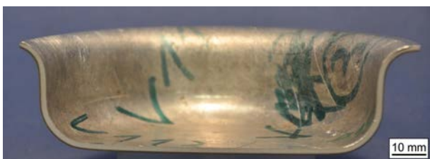
Abbildung 5: Querschnitt des Napfes aus dem Aluminium-Stahl-Verbund nach dem Tiefziehen
