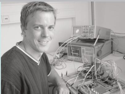
Erstmalige optische QPSK-Datenübertragung mit Standardlasern und Synchrondemodulation (<http://ont.upb.de/synQPSK>). Ein digitaler optischer Überlagerungsempfänger gewinnt Träger und Daten in Echtzeit zurück.
