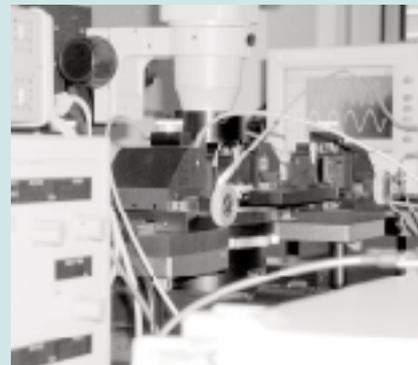
Hochfrequenzmessungen auf dem Wafer
