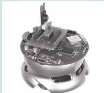
Miniroboter mit FPGA- und Kameramodul
