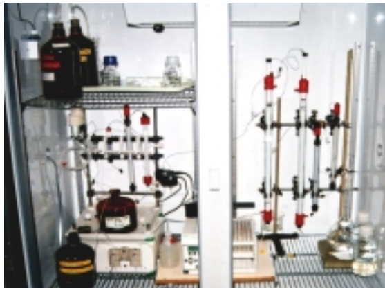
Abb. 64: Verwendetes Mitteldrucksystem (FPLC der Fa. Bio-Rad) für die GFC
