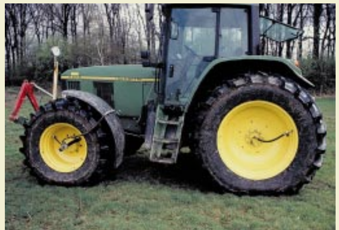
Bodenschonung und mehr Zugkraft beim Ackerreifendruck mit 0,5 bar am Traktor der Agrarwirtschaft Soest. Der niedrige Reifendruck macht die Reifen lang, vergrößert die Aufstandsfläche und spart Diesel.
