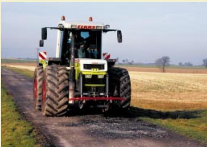
Fahrkomfortmessungen an einem Claas Xerion Traktor auf dem Feldweg. Die Reifenflanke wird elastisch und verbessert den Fahrkomfort.
