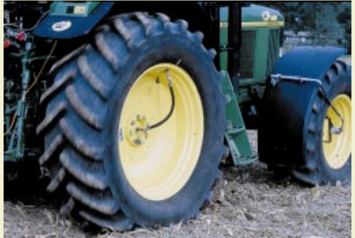
Zugkraftmessung auf dem Acker mit Zug- und Bremstraktor auf dem Feld der Agrarwirtschaft Soest. 25 Prozent mehr Zugkraft, bei gleichem Schlupf, gewinnt man durch einen niedrigen Reifendruck von 0,5 bar.
