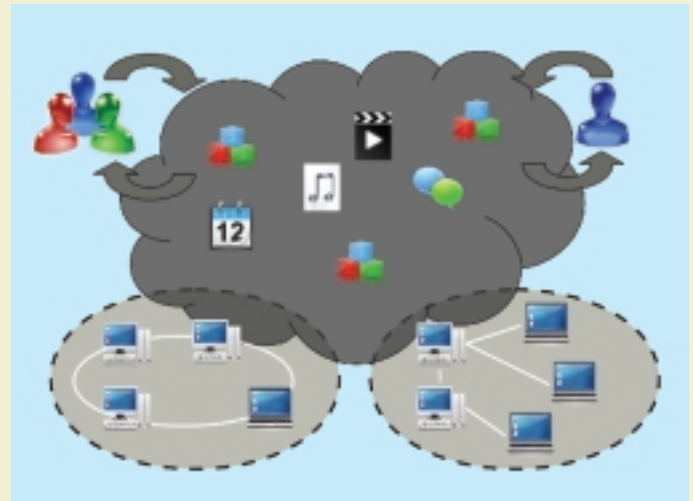
Abb. 6: Die Idee des Network of Information. Der Nutzer fragt direkt nach Informationen und das informationszentrische Netz wählt die „beste“ Kopie aus.
