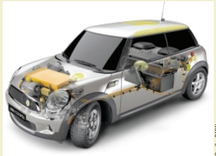
Abb. 2: Elektrofahrzeug 2009: Mini-E, Batterie 35 kWh, 150 kW Asynchronmotor, 152 km/h Höchstgeschwindigkeit, ca. 170 km Reichweite.
