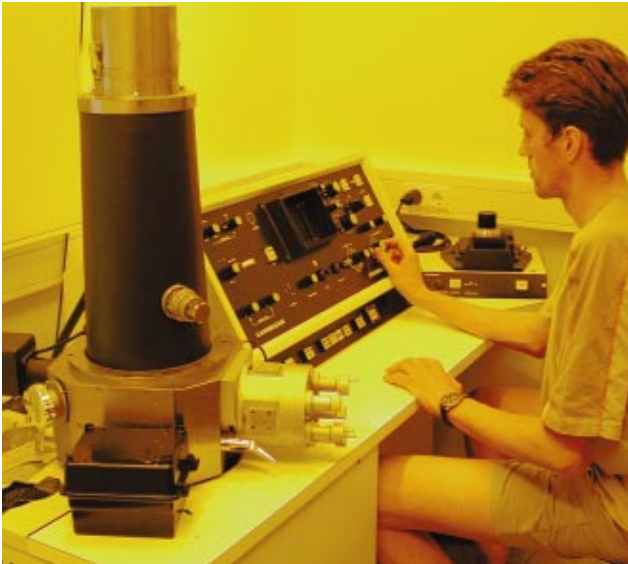
Martin Dierkes kontrolliert die durch eine Ätzung erzeugten Strukturen am Rasterelektronenmikroskop.
