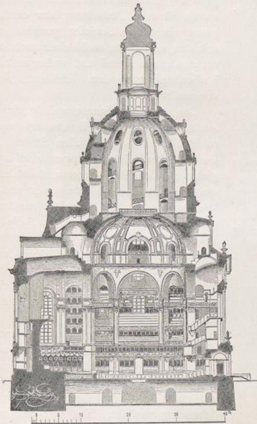
Abb. 240. Längsschnitt der Frauenkirche in Dresden.
