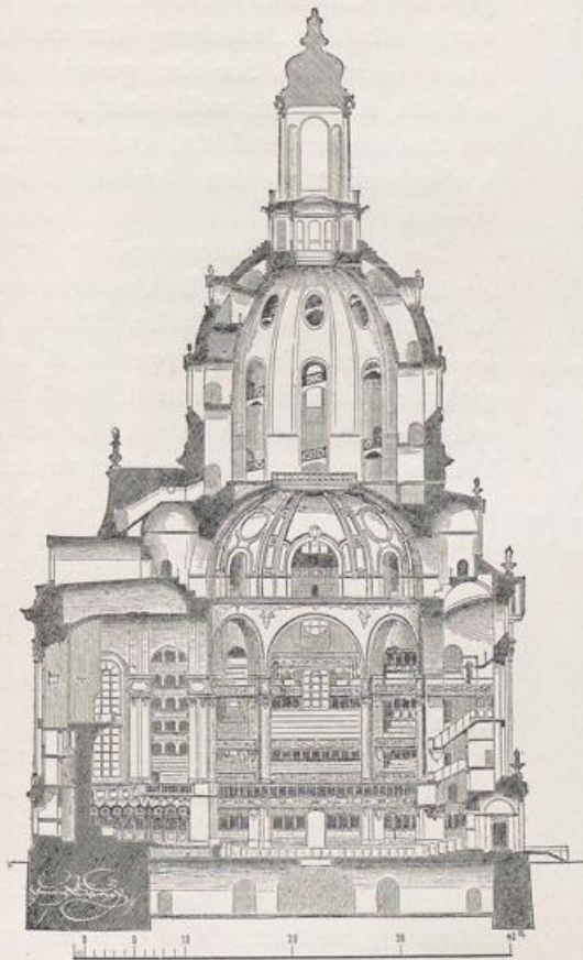
Abb. 240. Längsschnitt der Frauenkirche in Dresden.
