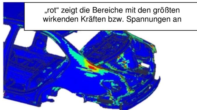
**Abbildung 3.13b: Torsionssimulation des Alltagsfahrbetriebs einer Karosserie**
