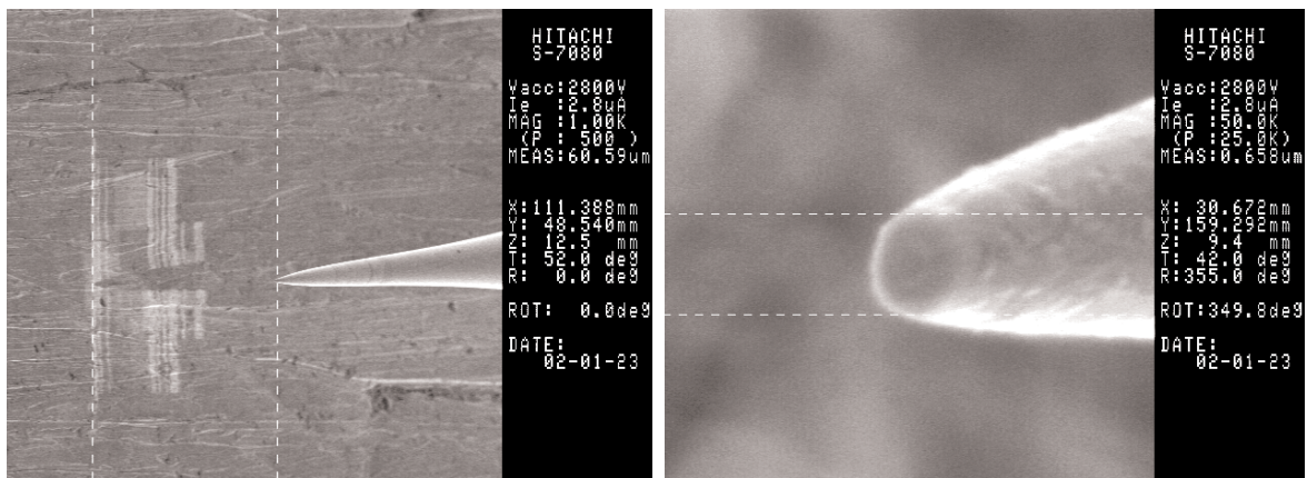
Abb. 6.8: Rasterelektronenmikroskopische Aufnahmen der mit einem Ionenstrahl modifizierten Glasfasern. Links: Verschiedene Schnittversuche an einer Glasfaserspitze. Es sind die Einschnitte im Probenhalter mit dem Schatten der Spitze zu sehen. Rechts: Glatte Stirnfläche einer Spitze mit Apertur nach dem Abschneiden.
