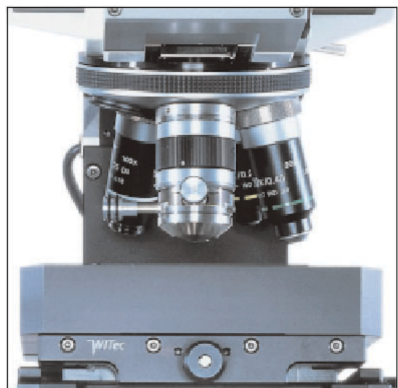
Abb. 6.1: Links: Prinzipieller Aufbau des WiTec Gerätes für Messungen mit der Rasterkraftmikroskopie, 1) Einkoppelung des IR-Laserstrahls zur Bestimmung der Verbiegung des Cantilevers, 2) Segmentierte Photodiode, 3) Cantilever, 4) Piezo-Tisch. Rechts: Objektiv mit Cantileverhalterung, darunter Piezo-Tisch nach [153].
