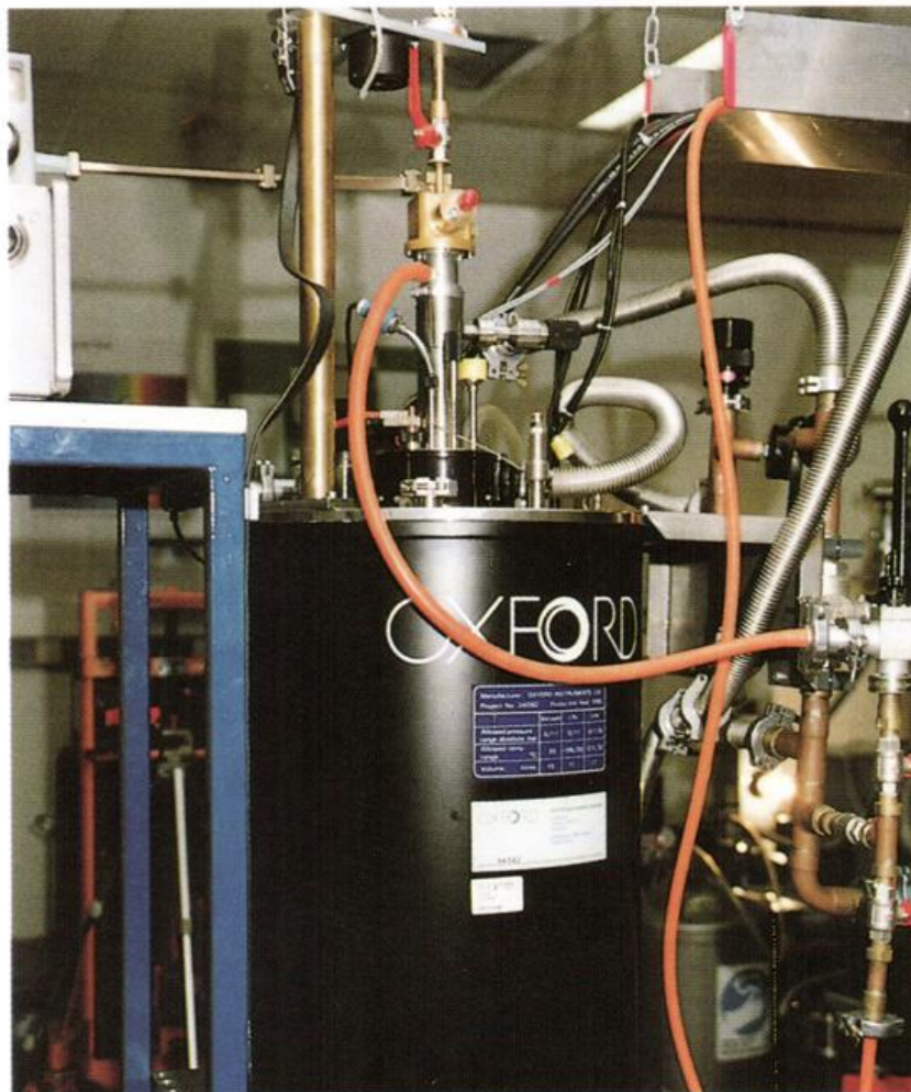
ODMR – Meßapparatur von Punktdefekten in Kristallen
