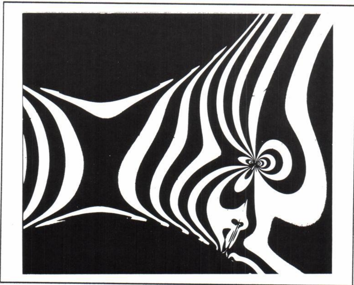
Spannungsoptische Aufnahme: Isochromatenverteilung in der Umgebung eines gekrümmten Eigenspannungsrisses
