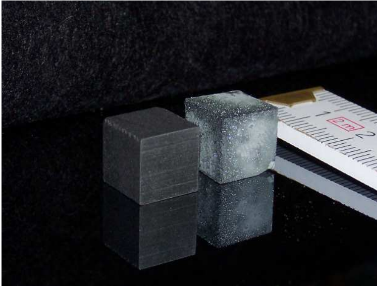
Fig. 4.36: Zum Vergleich ein Würfel aus Graphit, mit der Kantenlänge 10mm und ein 3C-SiC-Würfel direkt nach der Umwandlung (blau wg. Al-Dotierung).
