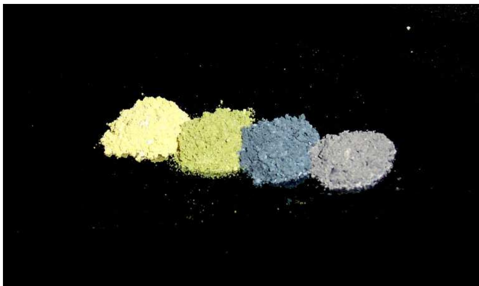
Fig. 4.16: Foto verschiedener stark dotierter mikrokristalliner Siliziumkarbid Proben, (von links) mit Phosphor (gelb), Stickstoff (grün), Aluminium (blau) und Bor (grau-braun) Dotierung.
