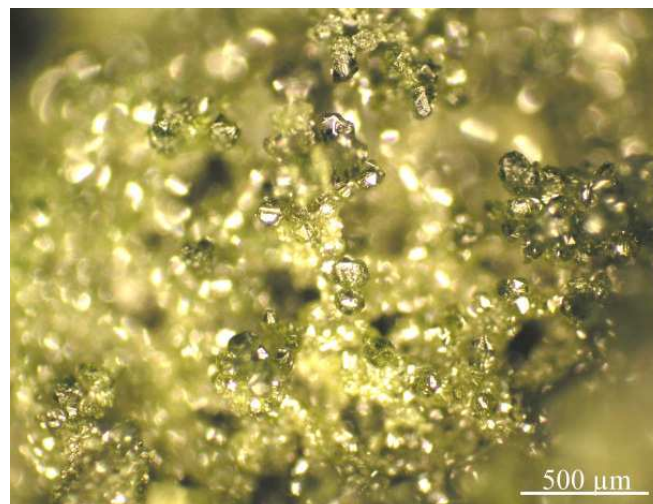
Fig. 4.10: Lichtmikroskopische Aufnahme von undotierten Siliziumkarbid-Mikrokristallen. Die enthaltenen Einzel-Kristallite haben eine Größe von bis zu 200\mu\text{m} .
