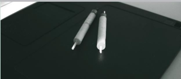
Bild 1: Foto zweier einkristalliner langlebiger Leuchtstoffe. Die Proben sind bereits an Styropor®-Probenhalter geklebt. Die Aufnahmen entstanden in normalem Tageslicht nach 10-minütiger Anregung mit Sonnenlicht
