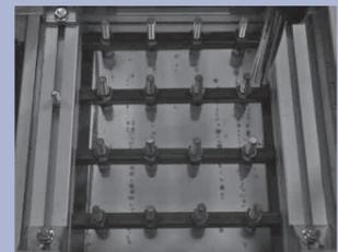
Warmformstähle wie der 22MnB5 müssen, um Festigkeiten im Bereich 1500 MPa zu erhalten, im Fertigungsprozess auf ca. 950 °C erwärmt werden. Dies geschieht konventionell durch Rollenherdöfen. In dem FOSTA-Forschungsprojekt „Induktives Erwärmen von Platinen für das Presshärten“ wird die Substituierbarkeit der konventionellen Öfen durch Induktoren untersucht.
