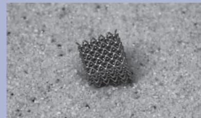
Im Rahmen des Direct Manufacturing Research Centers (DMRC) beteiligt sich das LiA an der Weiterentwicklung des SLM-Verfahrens. Mit dem SLM-Verfahren lassen sich metallische Strukturen additiv aufbauen, wodurch sich ein hoher Grad an Konstruktionsfreiheit eröffnet. Ziel des gesamten Projektes ist es, Serienprodukte mit definierten Eigenschaften herstellen zu können.
