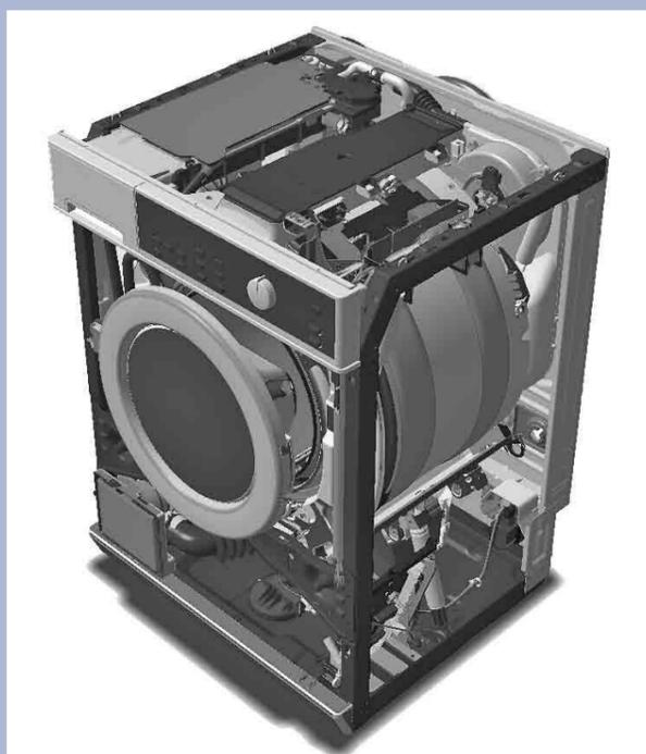
Digitale MockUp einer Waschmaschine für die Überprüfung von Bauräumen und Montageabläufen. (Quelle: Miele & Cie. KG)
