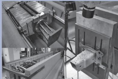
Bei einem KFZ-Unfall nehmen Stoßreduzierelemente kinetische Energie durch plastische Verformung auf und schützen die Insassen und folgende Bauteile. Im Schlittenprüfstand werden unterschiedliche Konstruktionen bei Variation der Geschwindigkeit und Masse getestet. Hierbei werden Kraft-Weg Verläufe und das Verformungsverhalten unter anderem durch Highspeed-Aufnahmen analysiert.
