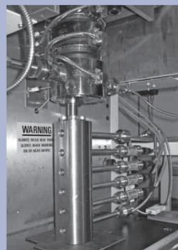
Versuchsaufbau zur Untersuchung von Wandgleiteffekten mittels einer Schlitzdüse
