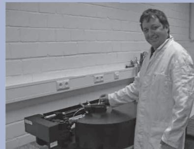
Mit dem neuen Goniometer lassen sich nun zeitgleich statische und dynamische Lichtstreuung (SLS/DLS) nutzen, um einen breiten Partikelgrößenbereich zu analysieren und unterschiedlichste Partikelformfaktoren zu bestimmen.
