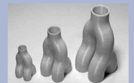
Beim FDM (Fused Deposition Modeling) wird thermoplastisches Material aufgeschmolzen und über eine Düse definiert aufgebracht - so entstehen schichtweise Bauteile unterschiedlicher Geometrie und Größe.
