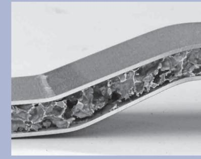
Untersuchung der Dauerbiegefestigkeit an Deckblechen aus AlMg3
