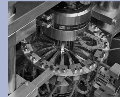
Belastungsdilatometer zur Messung der Kinetik der lastabhängigen Phasenumwandlung
