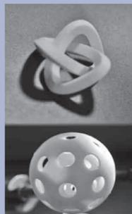
Durch Laser Sintering von Polymerpulvern lassen sich komplexe Geometrien in einem einzigen Prozessschritt direkt aus den CAD-Daten realisieren. Die entstehenden Produkteigenschaften können auf Grund verschiedener Materialien und Parameter gezielt variiert werden.
