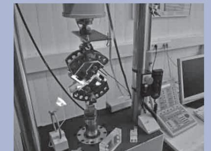
Experimentelle Untersuchung des Risswachstums im Labor der Fachgruppe Angewandte Mechanik
