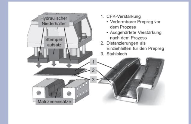
Leichtbau durch umformtechnisch hergestellte Stahlstrukturen mit lokaler CFK-Verstärkung für den Einsatz im Automobilbau
