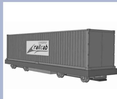
RailCab-Fahrzeug für Containertransport
