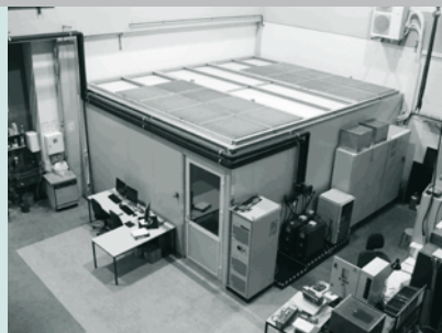
Klimakabine für hybride Fahrzeugantriebe
