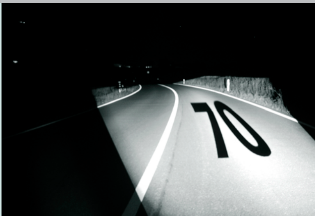
Projektion von Informationen mit einem Aktiven Scheinwerfer
