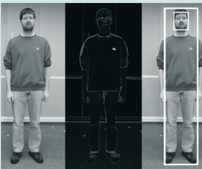
Personenlokalisierung und -erkennung: links: Originalbild, Mitte: extrahierte Kanten, rechts: detektierte Gesichts- und Körperregion
