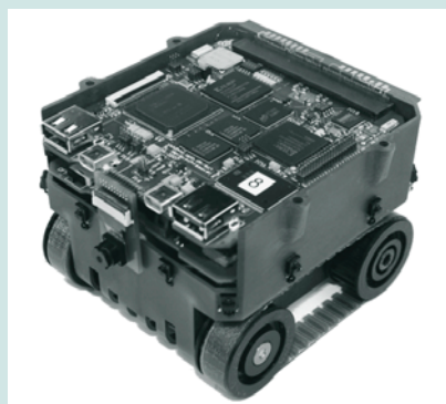
Miniroboter BeBot mit Mobilprozessor, FPGA- und Kameramodul
