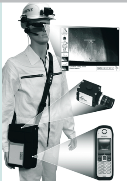
Remote Field Assistance (RFA): Eine gemeinsam mit dem Sector Energy und Corporate Technology der Siemens AG entwickelte Lösung für die weltweite Fernunterstützung von Wartungstechnikern. Die Bilder zeigen das mobile Technikersystem, das dazugehörige Infrastruktursystem für die satellitenbasierte Kommunikation zwischen dem Wartungsmitarbeiter vor Ort und dem Spezialisten und das Back Office System.
