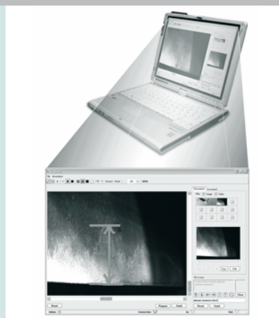
Remote Field Assistance (RFA): Eine gemeinsam mit dem Sector Energy und Corporate Technology der Siemens AG entwickelte Lösung für die weltweite Fernunterstützung von Wartungstechnikern. Die Bilder zeigen das mobile Technikersystem, das dazugehörige Infrastruktursystem für die satellitenbasierte Kommunikation zwischen dem Wartungsmitarbeiter vor Ort und dem Spezialisten und das Back Office System.
