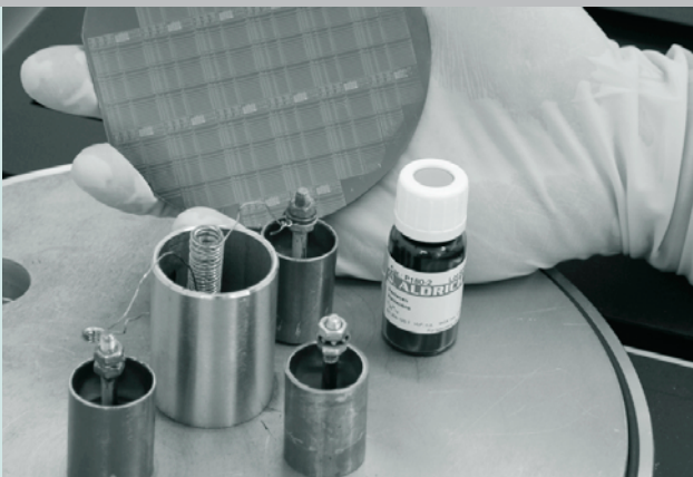
Organische Feldeffekt-Transistoren aus Pentacen auf Silizium-Substrat
