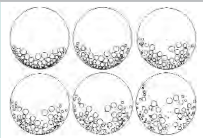
Simulation von gefüllten Hohlkugeln für Leichtbaustoffe
