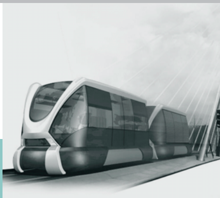
Oben: Das RailCab-System zeichnet sich durch kleine, autonom und bedarfsgerecht agierende Schienenfahrzeuge aus, die Passagiere und Güter individuell, schnell und komfortabel befördern.
