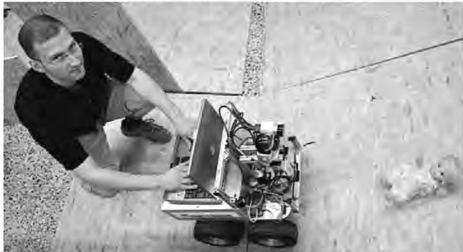
Retterungsroboter: Dipl.-Inform. Tobias Kothhäuser von der Universität Paderborn demonstriert ein aktuelles Forschungsprojekt aus dem „Get Lab“. Mit Hilfe von Sensoren sucht ein Rettungsroboter in einer Arena, die meist einem Katastrophenszenario wie nach einem Erdbeben ähnelt, ein „Opfer“.
