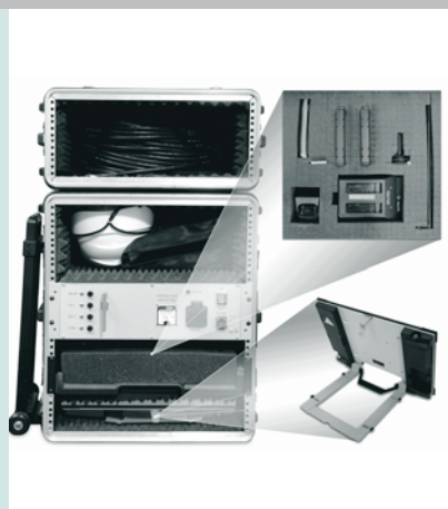
Remote Field Assistance (RFA): Eine gemeinsam mit dem Sector Energy und Corporate Technology der Siemens AG entwickelte Lösung für die weltweite Fernunterstützung von Wartungstechnikern. Die Bilder zeigen das mobile Technikersystem, das dazugehörige Infrastruktursystem für die satellitenbasierte Kommunikation zwischen dem Wartungsmitarbeiter vor Ort und dem Spezialisten und das Back Office System.
