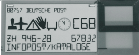
Oben: Prototyp eines drahtlos versorgten RFID-Systems mit intelligentem passivem Display (Pariflex).
