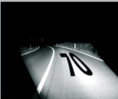
Oben: Projektion von Informationen mit einem aktiven Scheinwerfer
