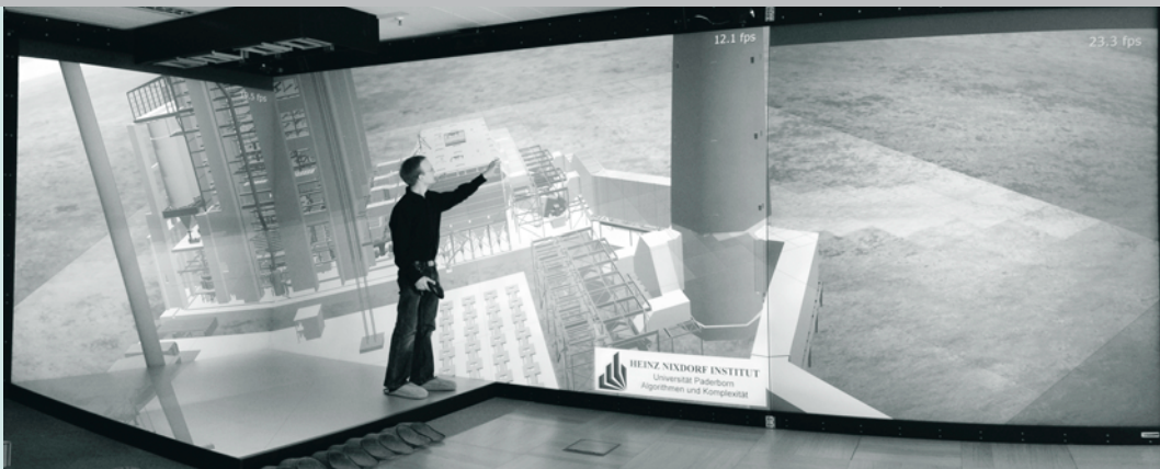
Standpunktabhängiges Rendering auf der Powerwall des HD-Visualisierungszentrums für Virtual Prototyping und Simulation (Heinz Nixdorf Institut)
