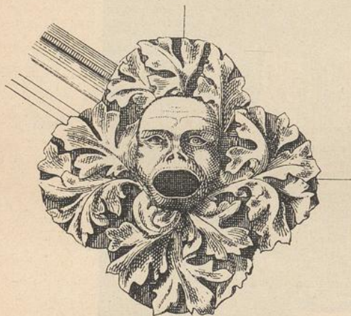
Kopf als Schlussstein mit Lüftungsöffnung 181) .
