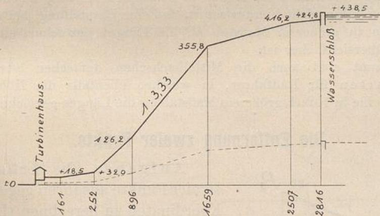
Fig. 8. Längsprofil einer Rohrleitung.
