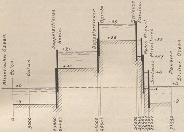
Fig. 7. Längsschnitt des Panamakanals.
