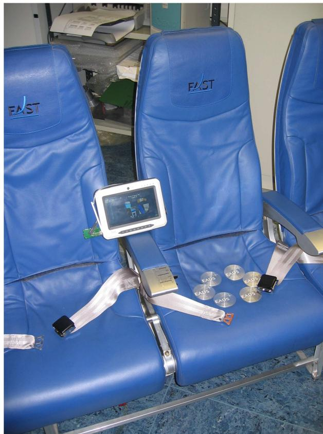
*Abbildung 81: Integration des EADS Demonstrators zur Sitzplatzüberwachung in einem Flugzeugsitz und die dazugehörige Ausleseinheit*
