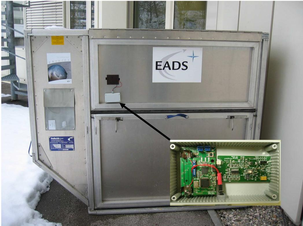
Abbildung 84: Bild eines Containers mit Intrusion Detection und Solarzelle als Energieversorgung
