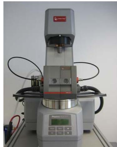
Abb. 1: Rotationsrheometer MCR501 der Fa. Anton Paar, mit Konvektionsofen.
