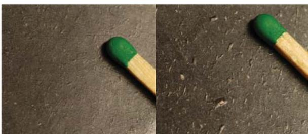
Abb. 4: WPC-Bauteiloberfläche vor (oben) und nach Wasserlagerung (AK Schöppner)
