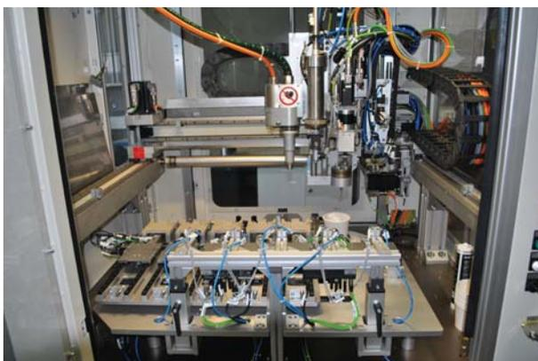
Vollautomatisierte Klebanlage. Die Anlage ist unter anderem mit einer klimatisierbaren Zelle ausgestattet und enthält eine frei programmierbare CNC Steuerung.
