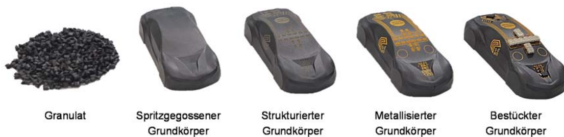
Bild 2-5: Fünf Fertigungsstufen vom Granulat zum fertigen Produkt [For15a-ol]
