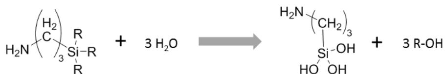
Abbildung 6: Hydrolyse von  $\gamma$ -Aminopropyltrimethoxysilan<sup>[35]</sup>
