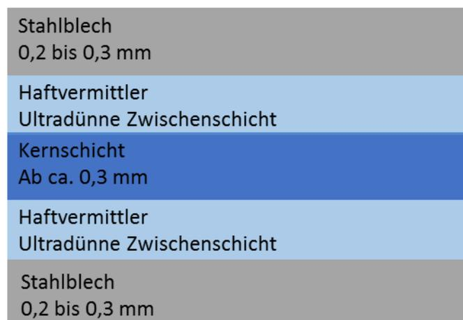
Abbildung 1: Schematischer Aufbau des Sandwichwerkstoffes im Detail - nicht maßstabsgetreu
