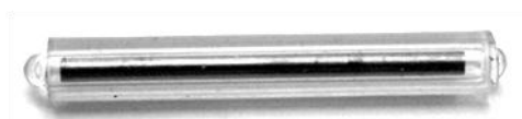
Abbildung 5-3: Twister®-Rührstab (Länge 2 cm, Schichtdicke der PDMS-Phase 1 mm), im Inneren ist der glasummantelte, magnetische Kern zu erkennen.
