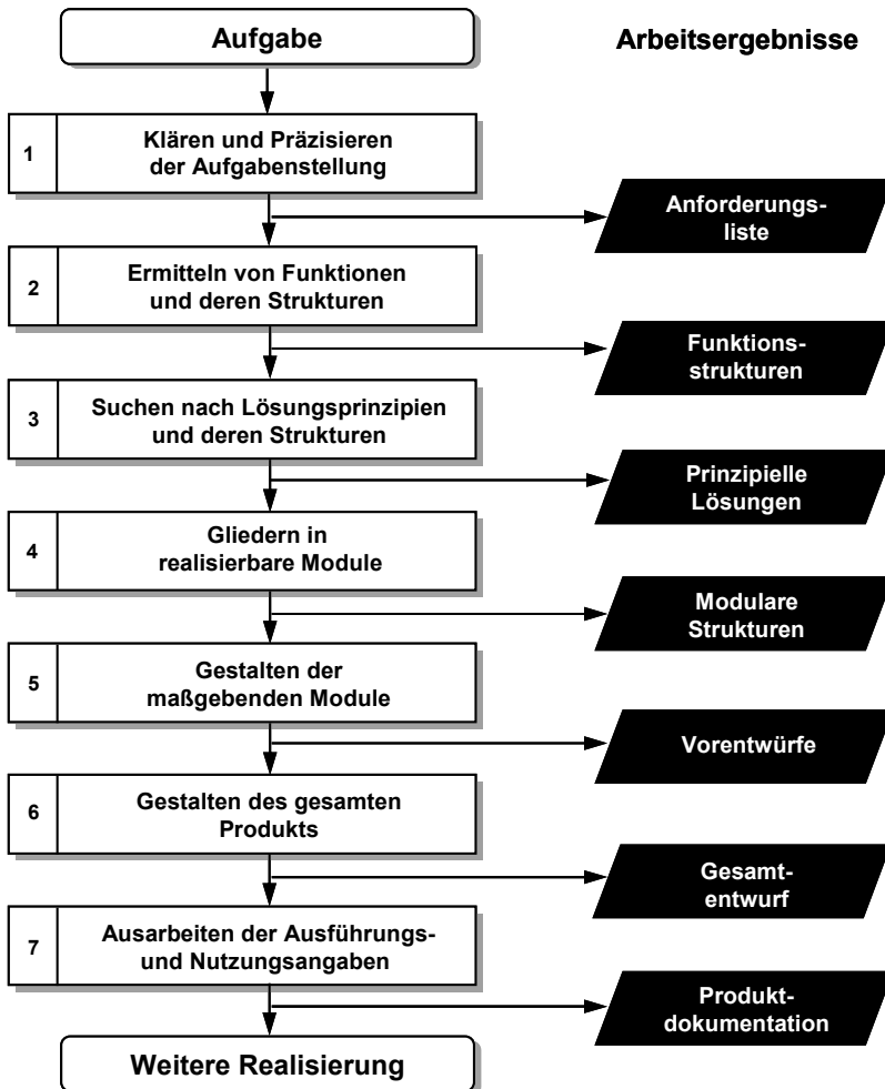
Bild 3-1: Vorgehen beim Entwickeln und Konstruieren nach VDI 2221 [VDI2221, S. 9]
