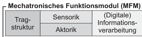
Abbildung 2.8: Aufbau eines mechatronischen Funktionsmoduls nach [HNHS94]
