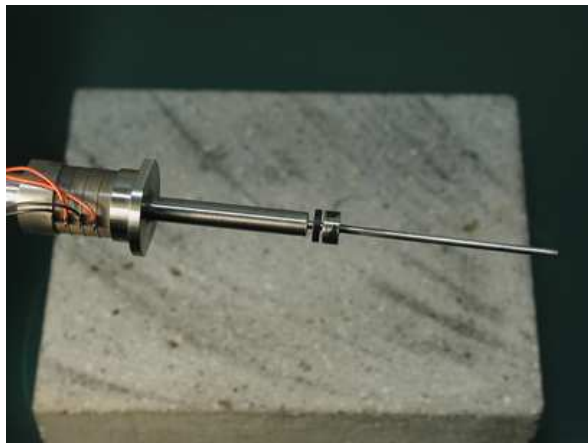
Bild 3.1: Prototyp des Stoßbohrers für Laborexperimente
