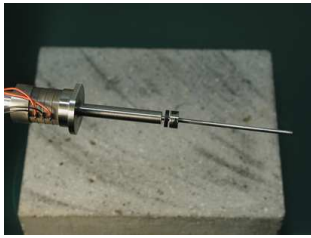
Bild 6.2: Stabführung gelochter Scheibe
