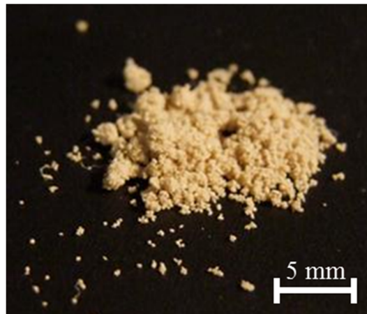
Abbildung 4-38: Durch die Laservorbehandlung entstandene Ablationsreste auf der Oberfläche [131, 142]
