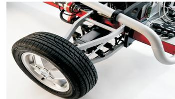
Radmodul mit drei Elektromotoren
