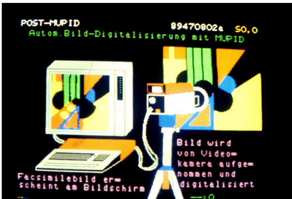
Bild 8: Mit MUPID und Videokamera war eine direkte Bildabspeicherung möglich.
