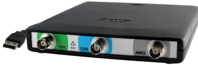
Abbildung 5.6: Handyscope HS5 vom Unternehmen Tiepie engineering, Niederlande [Tie14].
