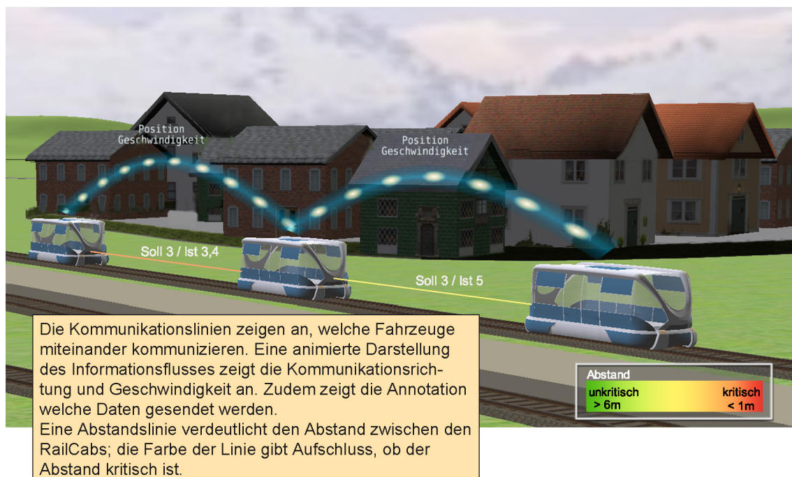
Bild 6-5: Zoomstufe 3, AMS (ein Konvoi): Visualisierungstechniken geben Aufschluss über Informationen, die innerhalb eines Konvois ausgetauscht werden: Abstände, Position und Geschwindigkeit
