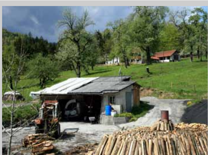
Abb. 5 Köhlererei in Grünburg. Im unteren, rechten Bereich der Fotografie erkennt man die Holzscheite, aus denen das Innere des Kohlemeilers besteht und die nach der Reaktion als Holzkohle verkauft werden können.
