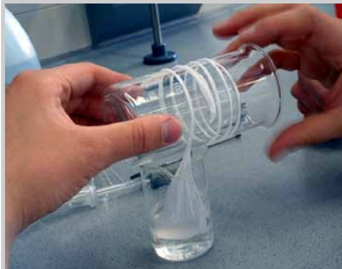
Abb. 14 Entstehung eines Nylonfadens
