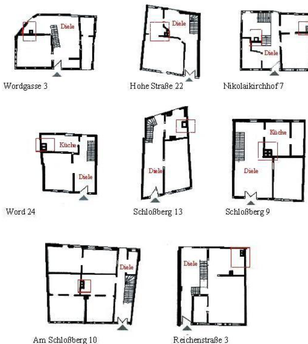
Abb. 2 Grundrisse (Unterstock) von Bürger- und Handwerkhäusern. Quelle: Eigene Zeichnung nach Helmut Stelzer, 1976
