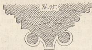
Quergurtprofil im Schiffgewölbe von St. Maria auf dem Capitol zu Köln. (F. K.)
