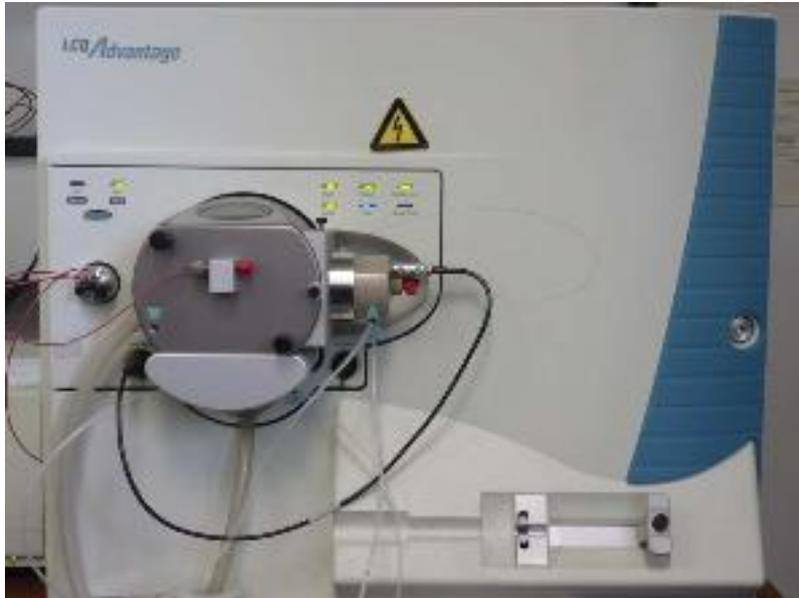
**Abb. A 1:** LCQ-Advantage: Dreidimensionale Ionenfalle (Iontrap)
