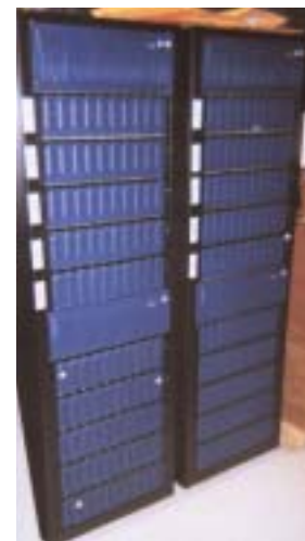
TP9400 Festplattensystem mit 1 Terabyte Speicherkapazität basierend auf RAID-Technologie.
