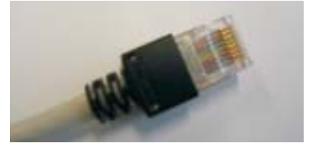
Die Basis des Netzwerks - Twisted Pair Kabel
