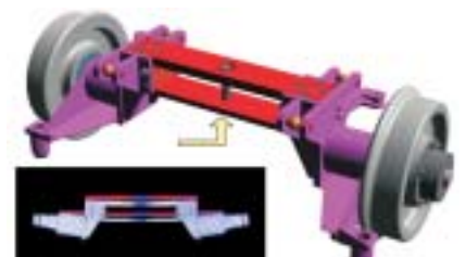
Direkte Messung der Beanspruchung an der Achse.
