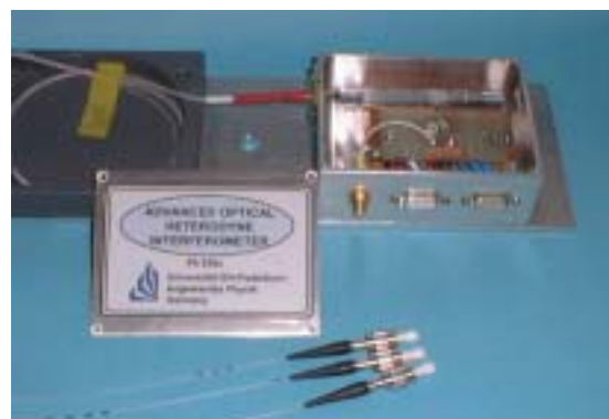
Abb. 3 Integriert akustooptisches Heterodyninterferometer mit Glasfaseranschlüssen.
