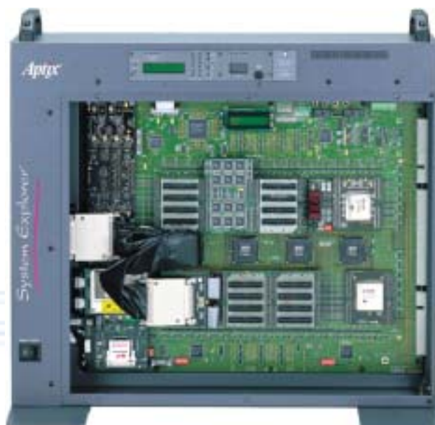
Prototyping-System für komplexe Prozessorarchitekturen
