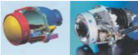
CAD-Modell und Baugruppe eines modernen Scheinwerfersystems.
