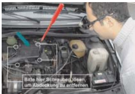
AR-Szene: In das Sichtfeld des Anwenders werden über ein Head Mounted Display Montagehinweise eingeblendet.
