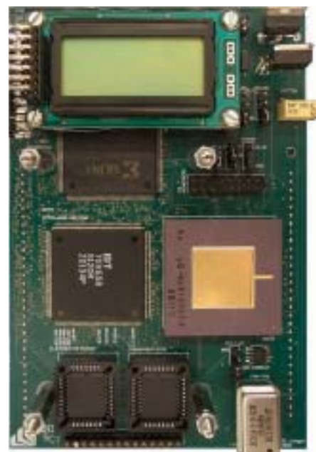
Modul zur Integration des am Fachgebiet Schaltungstechnik entwickelten Prozessorkerns S-Core in das RAPTOR2000-System.
