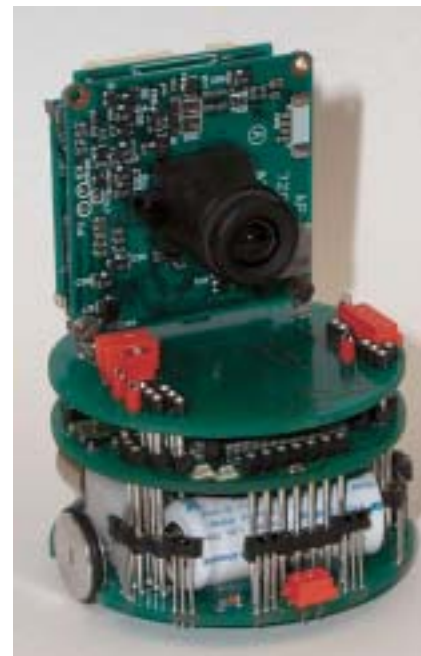
Der Miniroboter Khepera mit einem Kameramodul für Cheap Vision.
