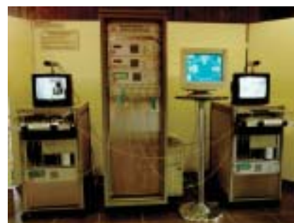
Abb. 2 Optisches Übertragungssystem mit integriert akustooptischen Schaltkreisen in den Vermittlungsstellen. (Beitrag u.a zur Ausstellung „Stein der Weisen“ im Deutschen Bundestag in Bonn im September 2000 anlässlich des Jahres der Physik).
