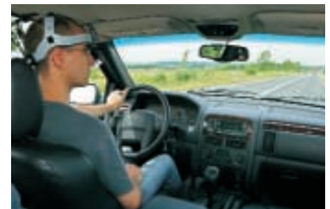
Eye-Tracking-System im Einsatz bei Testfahrten
