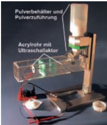
Bild 1: Technologiedemonstrator zum Pulvertransport durch Ultraschall
