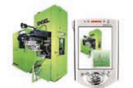
Darstellung von Simulationsergebnissen auf einem mobilen Endgerät mit Hilfe der AR-Technologie
