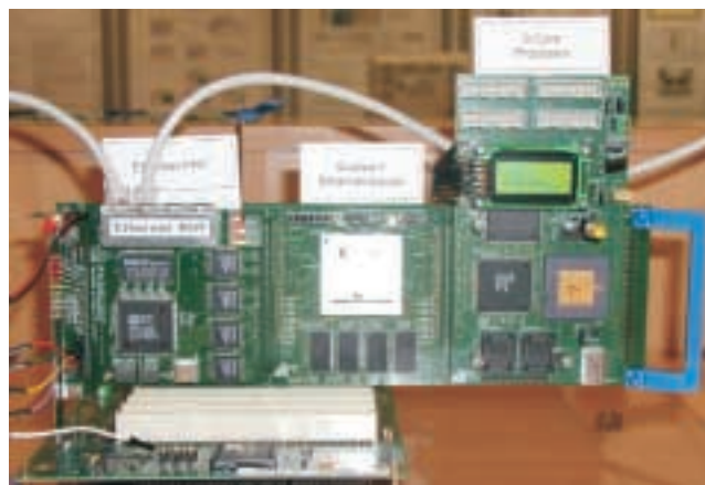
Dualport-Ethernet-Switch, realisiert mit dem Rapid-Prototyping-System RAPTOR2000
