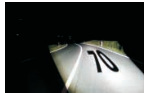
Projektion von Informationen mit einem aktiven Scheinwerfer
