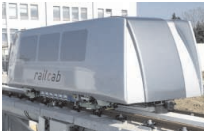
Railcab-Versuchsfahrzeug im Maßstab 1:2,5
