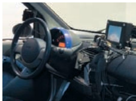
Armaturenbrett des Nachtfahrtsimulators, mit Eye tracking System und Prototyp eines IR-Nachtsichtdisplays
