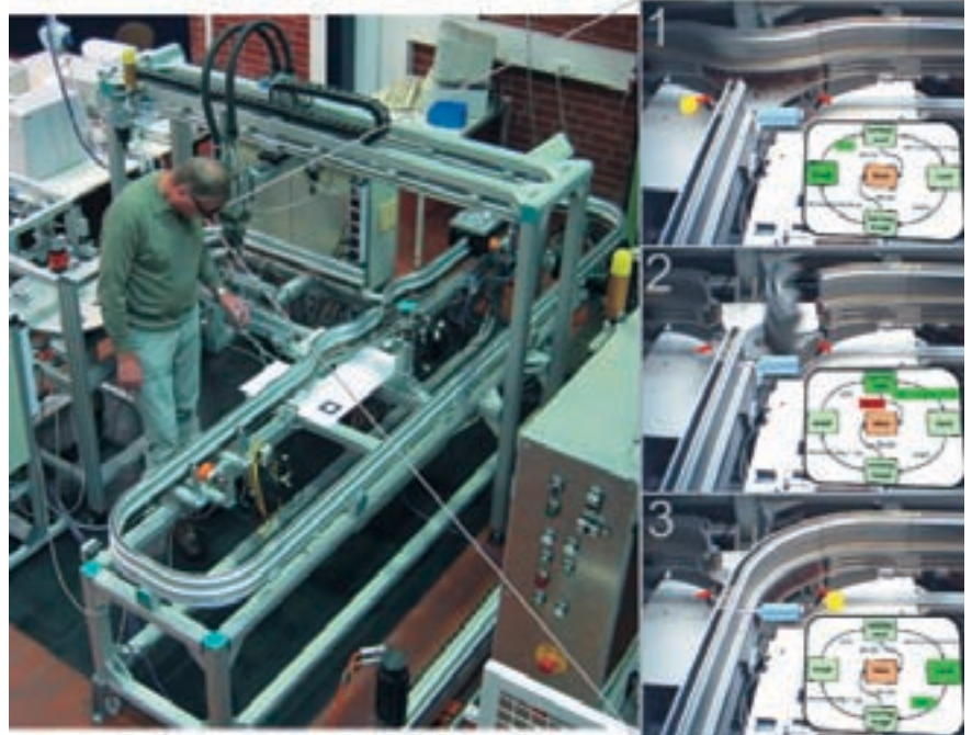
Einsatz von Augmented Reality im flexiblen Fertigungssystem: Darstellung der verschiedenen Zustände während eines Schaltvorgangs einer Weiche (computergenerierte Informationen: Zustandsdiagramm der Steuerungssoftware, pneumatischer Zylinder und induktive Näherungssensoren)
