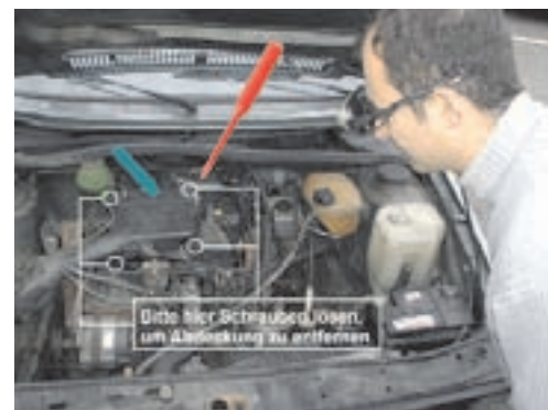
AR-Szenario: Die Reparaturanleitung wird in das Sichtfeld der Arbeitsperson eingeblendet
