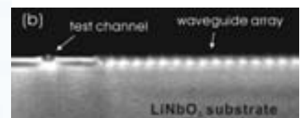
Abb. 3: Abbildung der Stirnfläche eines Wellenleiter-Arrays mit 101 gekoppelten optischen Wellenleitern.
