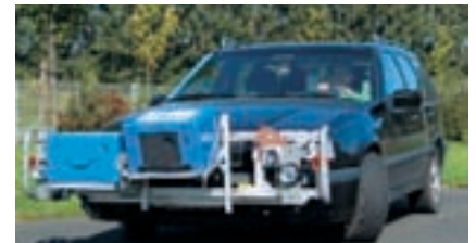
Das von Jacek Roslak und Rainer Kauschke entwickelte System zur blendungsfreien Ausleuchtung des Verkehrsraumes, basierend auf einem aktiven DMD-Scheinwerfer (Digital Micromirror Device) in Kombination mit einem vorausschauenden Sensor
