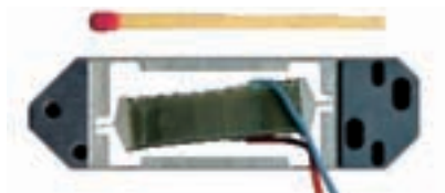
Piezoelektrischer Stellaktor mit Hebelübersetzung zur Feinpositionierung
