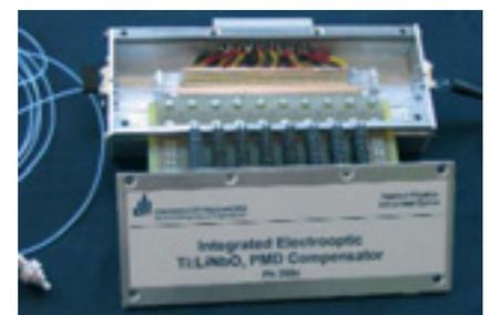
Abb. 3. Mit Glasfaseranschlüssen versehener, elektrooptischer PMD-Kompensator für hochrate Übertragungsstrecken der optischen Nachrichtentechnik.
