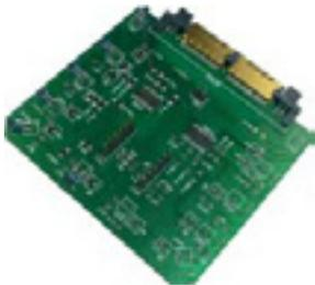
Testplatine für die Sensorvorverarbeitung
