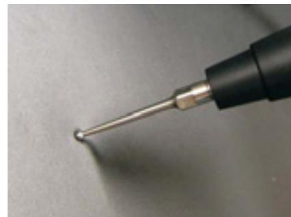
Piezelektrischer Ultraschallschwinger für die intraoperative Gewebsdifferenzierung
