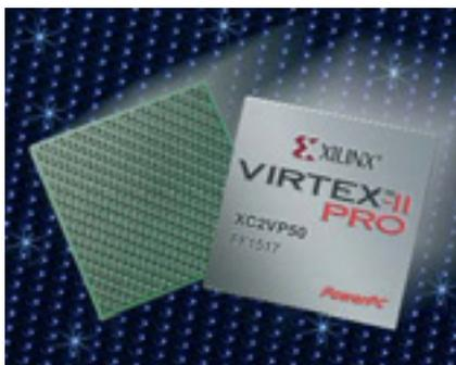
Der Xilinx Virtex II Pro FPGA verfügt über die Fähigkeit zur partiellen Rekonfiguration
