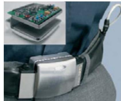
QBIC: Leistungsfähiger Computer versteckt in einer Gürtelschnalle (Quelle: ETH Zürich)
