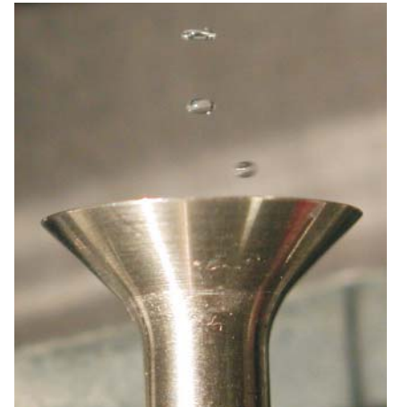
Bild 1: Levitation von Flüssigkeitstropfen in einem Ultraschall-Stehwellenfeld
