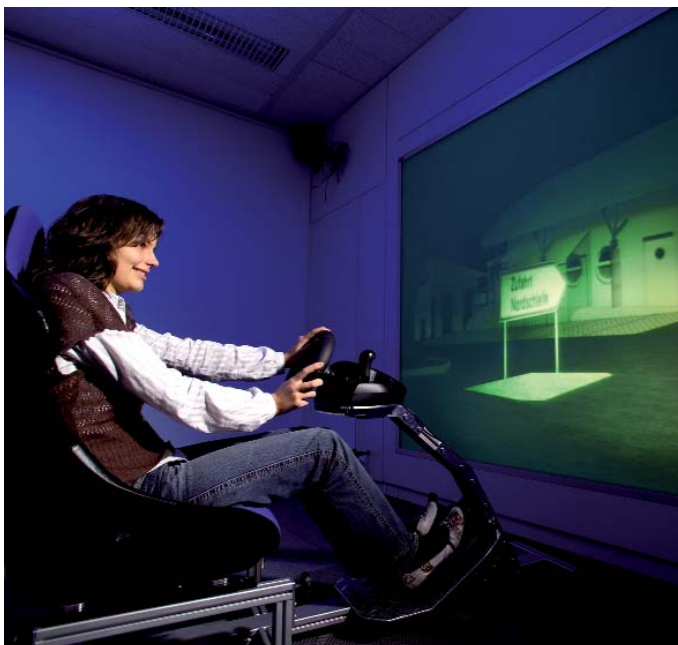
Virtual Prototyping von Scheinwerfersystemen mit dem Nachtfahrsimulator Virtual Night Drive
