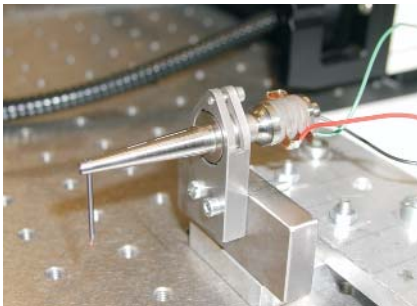
Piezoelektrisches Werkzeug für das Ultraschall-Drahtbenden
