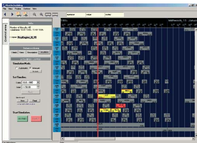
Reparaturvorschlag für einen gestörten Flugzeugeinsatzplan. Jede Zeile beschreibt die Flüge, die ein bestimmtes Flugzeug auszuführen hat.
