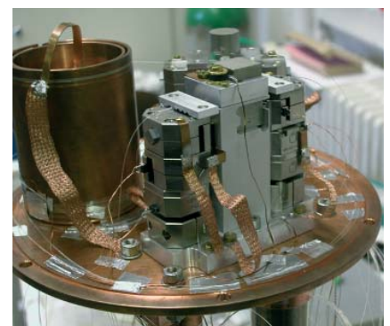
Abb. 3. Experimenteller Aufbau, um bei tiefen Temperaturen „Photonenechos“ in Erbium-dotierten Wellenleitern in Lithiumniobat zu demonstrieren. Entsprechende Strukturen kommen als Speicher für einzelne Photonen in Betracht, wie sie in der Quanten-Informationsverarbeitung benötigt werden (Aufbau von W. Tittel und N. Gisin, Universität Genf).
