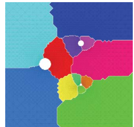
Aufteilung eines adaptiv verfeinerten Simulationsgebietes gemäß unseres neuen Verfahrens.
