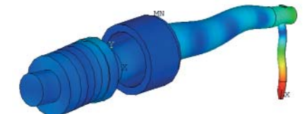
FEM-Modell der Bondsonotrode
