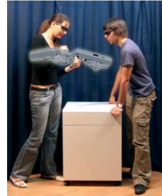
Einblendung von virtuellen Objekten (hier ein vergrößertes Scharnier) in das Sichtfeld der Benutzer.
