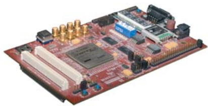
Avnet Virtex Board: Eine von mehreren Testplattformen für das Echtzeitbetriebssystem DREAMS
