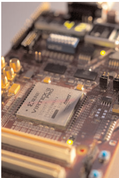
Avnet Virtex Board: Eine von mehreren Testplattformen für das Echtzeitbetriebssystem DREAMS
