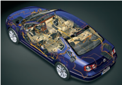
ECU-Netzwerk als Zielplattform für Zeitmodellierungen im TIMMO Projekt (Abb. der VW AG)
