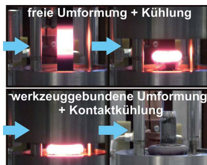
Lokal induktiv erhitze Stahlwelle im Umformprozess (Teilprojekt A1, Prof. Steinhoff, Universität Kassel)
