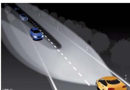
Demonstrator der Firma Hella: Scheinwerfer mit integriertem Schwenksystem zur Erzeugung einer adaptiven Hell-Dunkel-Zone
