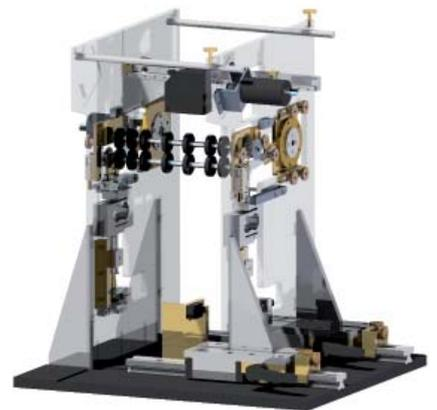
Prüfstand zur Vermessung von Komponenten eines Geldautomaten
