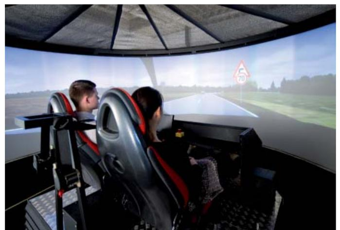
Probefahrt im Fahrsimulator für die Evaluation von Fahrerassistenzsystemen
