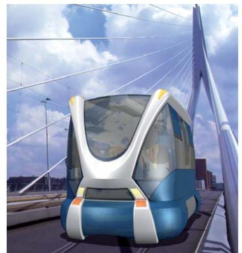
Das innovative Bahnsystem RailCab des Projekts „Neue Bahn Technik Paderborn“ wurde vollständig modelliert und im Maßstab 1:2,5 realisiert (<http://nbp-www.upb.de>)
