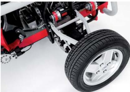
Radmodul mit drei Elektromotoren
