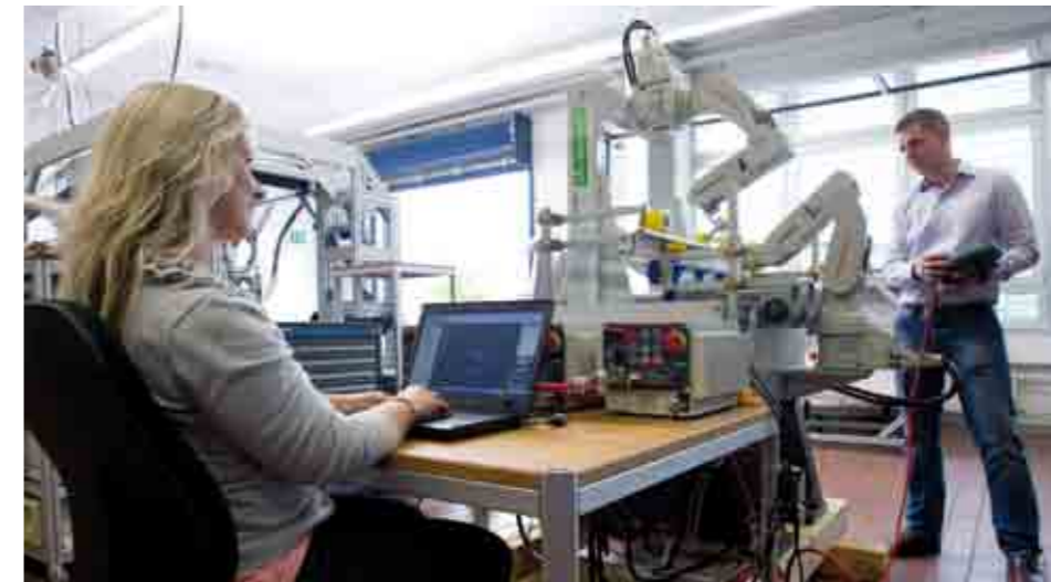
Modellbasierte Prüfstandsbetriebnahme mittels Rapid Control Prototyping. Model-based test bench setup by rapid control prototyping.
