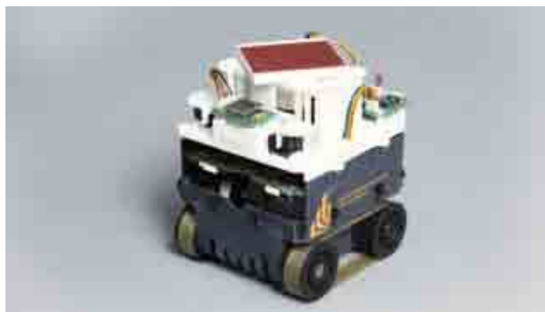
Roboter mit lasergesinterter Erweiterungsplattform Robot with laser-sintered platform
