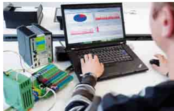
Simulation einer Steuerung zur Ermittlung der zukünftigen Belastung Simulating a PLC to predict its utilization
