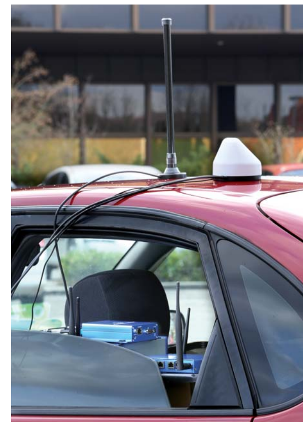
Aufbau eines Feldtests zum Untersuchen von Fahrzeugkommunikation Setup of a field test to study vehicular communications
