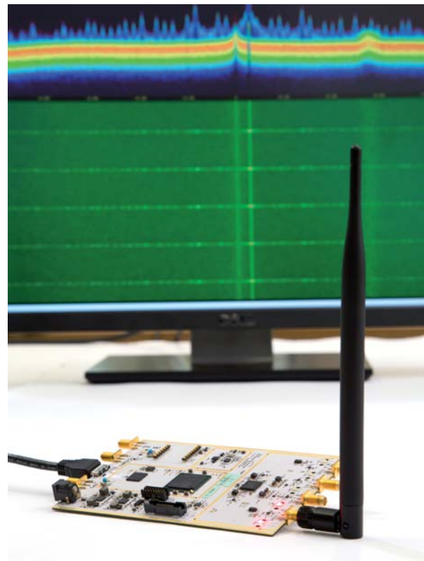
Ein SDR visualisiert die Auslastung des Funkspektrums An SDR visualizes the occupation of the frequency spectrum
